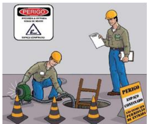
Ventilação e Sinalização (Fundacentro, 2009)
